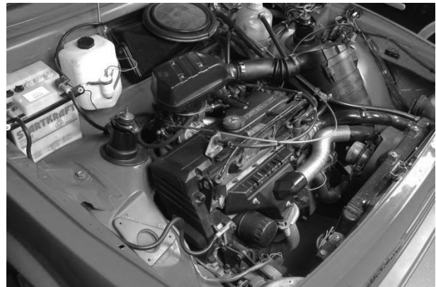
Renault 1.4 Antrieb im Wartburg 1.3 © AWE – Die Ausstellung – 2007;
